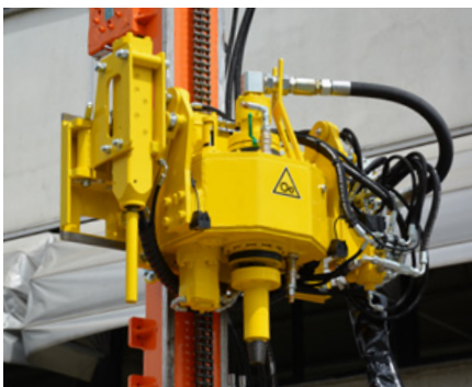
Testa di rotazione con martello a percussione Rotary head with hydraulic hammer Tête de rotation avec marteaux hydraulique Drehkopf bei hydraulischer Hämmer Cabeza de rotación con Martillo Hidráulico Головка вращения с ударным молотом
