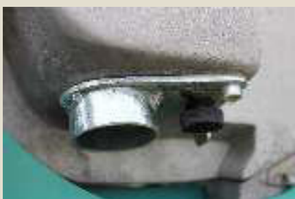
Tubo di scarico del seme Seed discharge pipe
